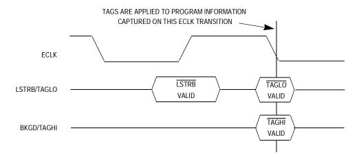
Figure 8-6. Tag Input Timing
